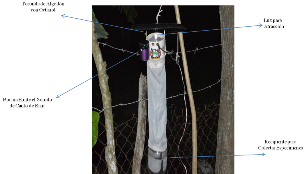
Fig. 2 Trampa CDC con atrayente de sonido de canto de ranas
